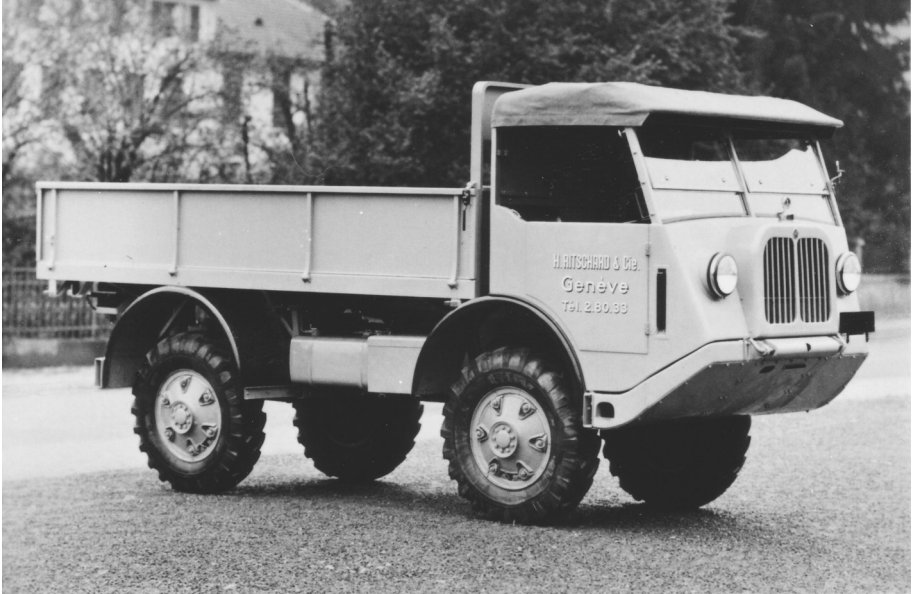
Zwei Zivilisten: Saurer 4M 24621/6 von H. Ritschard & Cie., Genf von 1938 mit CBDM-Motor und kleiner Kühlermaske [oben] und 24773/1 von Locher & Cie, Zürich von 1941 mit CR1DM-Motor und grosser Kühlermaske, analog den späteren 6M und 8M [unten].
