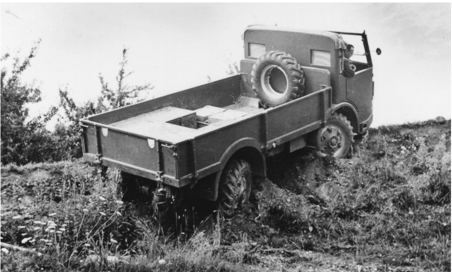
Der 4M wurde auch mit schwerem und tiefem Terrain fertig! Gut sichtbar am Heck ist die Kletterachse, welche hier trotz „Schneekette“ nicht gebraucht wurde.
