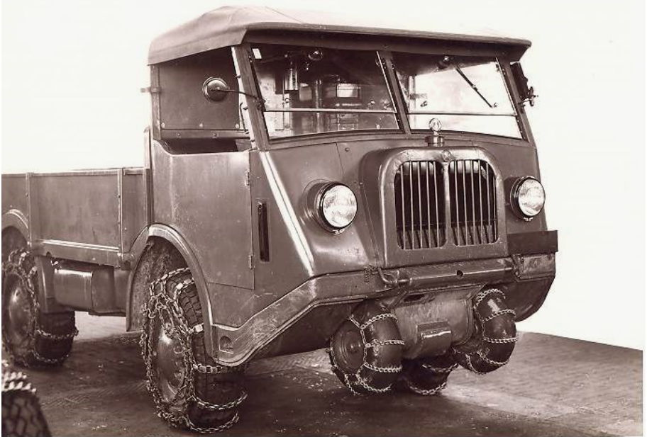
Saurer 4M CBDM mit kleiner Kühlermaske und Kletterachse.
