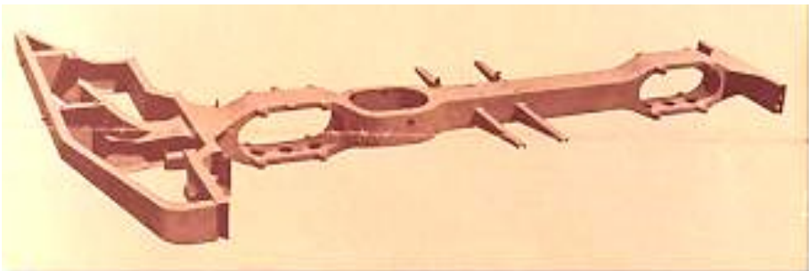
Der Zentralrohrrahmen des Saurer 4M.
