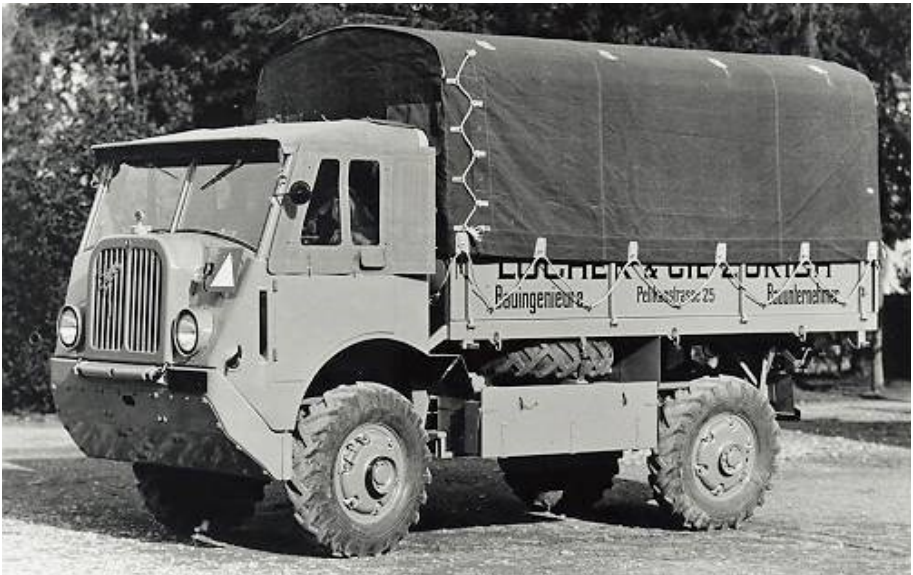
Zwei Zivilisten: Saurer 4M 24621/6 von H. Ritschard & Cie., Genf von 1938 mit CBDM-Motor und kleiner Kühlermaske [oben] und 24773/1 von Locher & Cie, Zürich von 1941 mit CR1DM-Motor und grosser Kühlermaske, analog den späteren 6M und 8M [unten].
